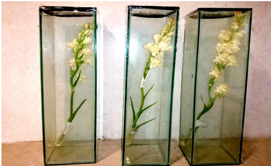
شکل ۱. ظروف شیشه‌ای طراحی شده جهت نمونه برداری و تعیین عطر گل مریم
